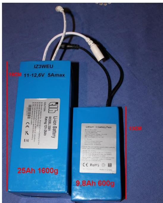
I pacchi hanno come dato di targa una corrente massima di 2,5 A o 5 A (9,8 Ah e 25 Ah) sempre sotto controllo dal PCM.
